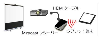
タブレット端末を Miracast レシーバー (6000 円程度) に無線で接続し、レシーバーをHDM I ケーブルでプロジェクタ、または液晶テレビに接続する。これでタブレットの画面をスクリーンに映し出す(ミラーリング)。
