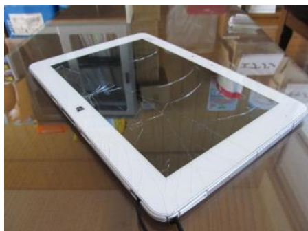
【落下により画面に入ったひび】
